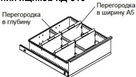
1xКД-516/536 Перегородка в глубину +4xКД-516/536 Перегородка в ширину А5 (две ячейки с шириной 229 мм)
